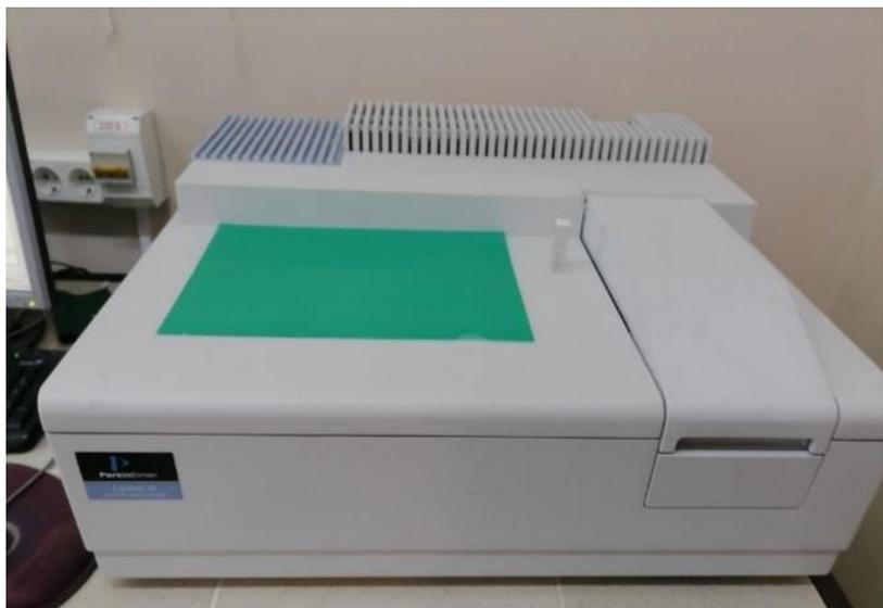
Рисунок 15 – Внешний вид УФ-спектрометра
