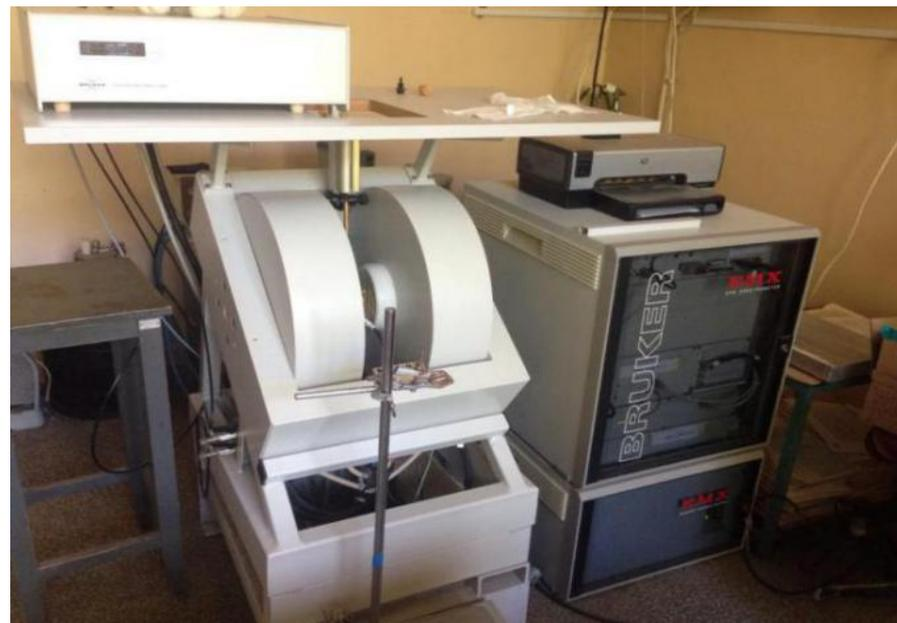
Рисунок 12 – Установка ЭПР-спектрометра
